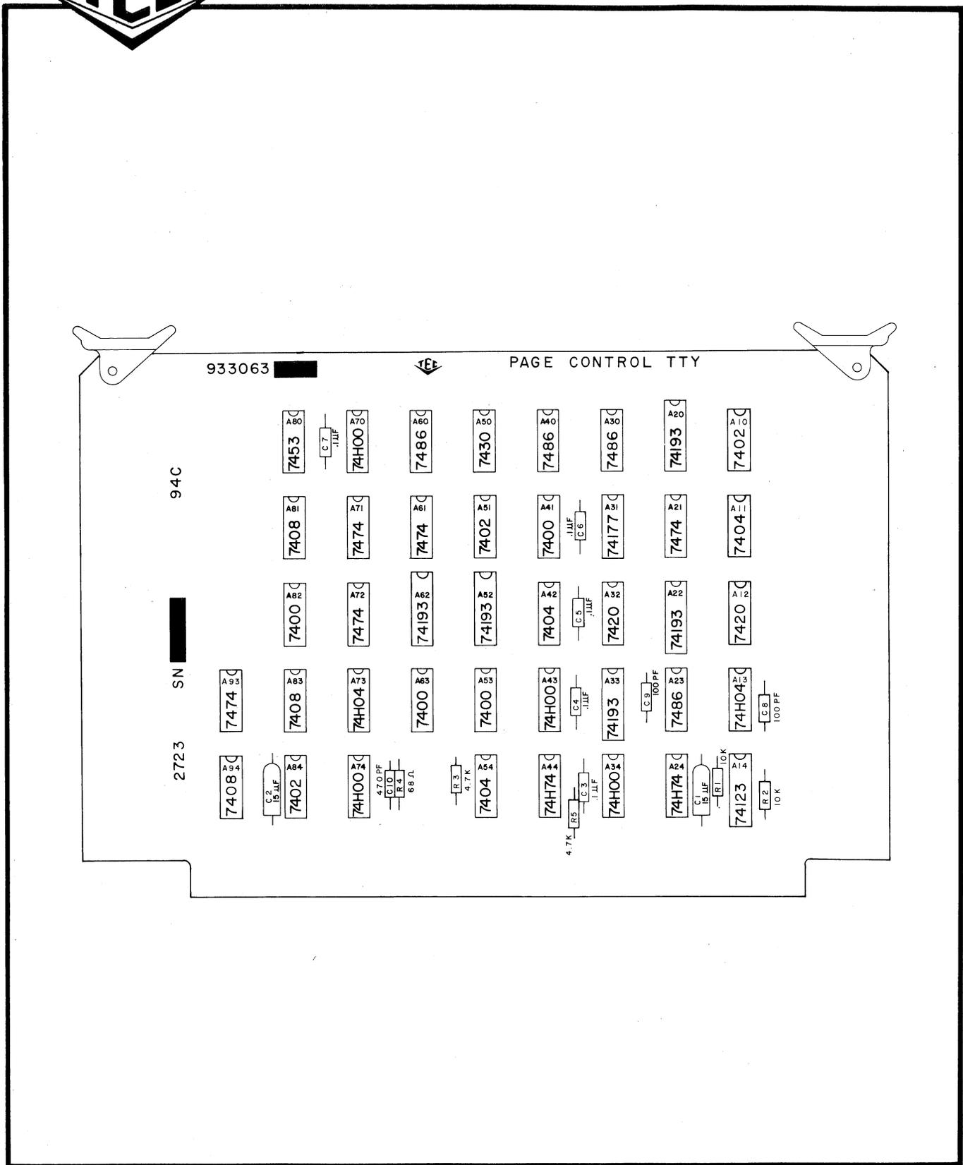
FIGURE 23 MODEL 440 PAGE CONTROL PRINTED CIRCUIT BOARD
