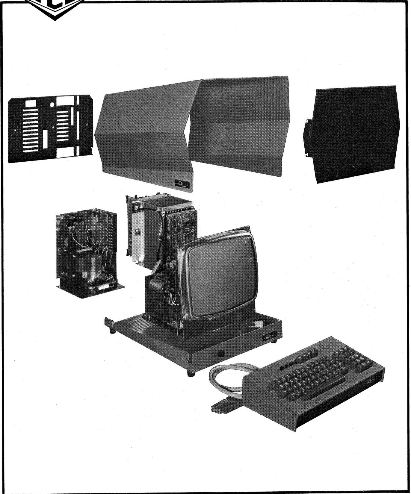
FIGURE 28 EXPLODED VIEW - TYPICAL DATA-SCREEN TERMINAL ASSEMBLY
