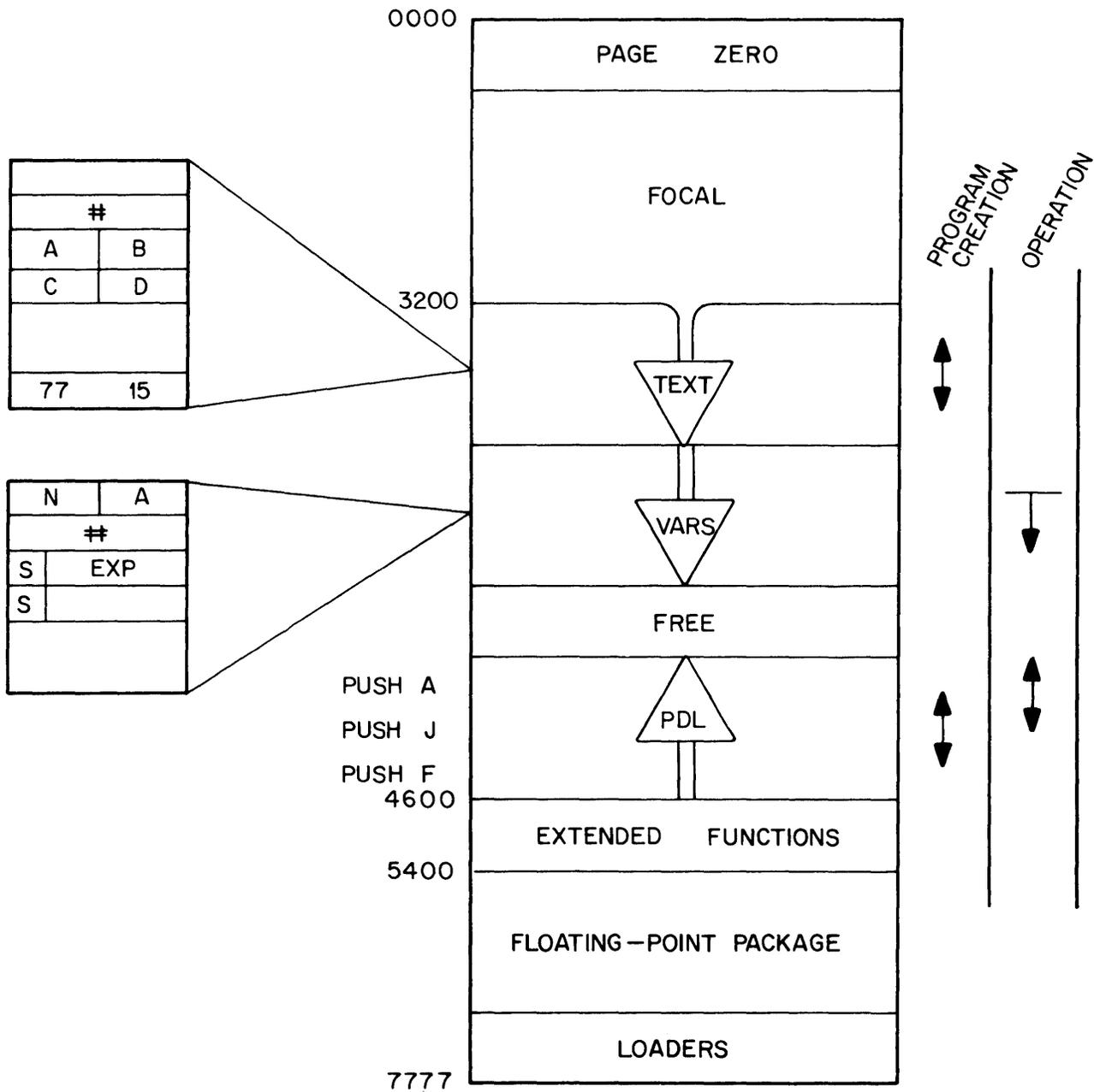
Figure D-1 FOCAL Core Layout
